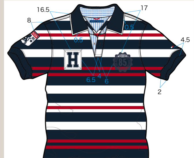
工場へ送られる指示書に添付されるデザイン画、詳細な数値が入力されている。
