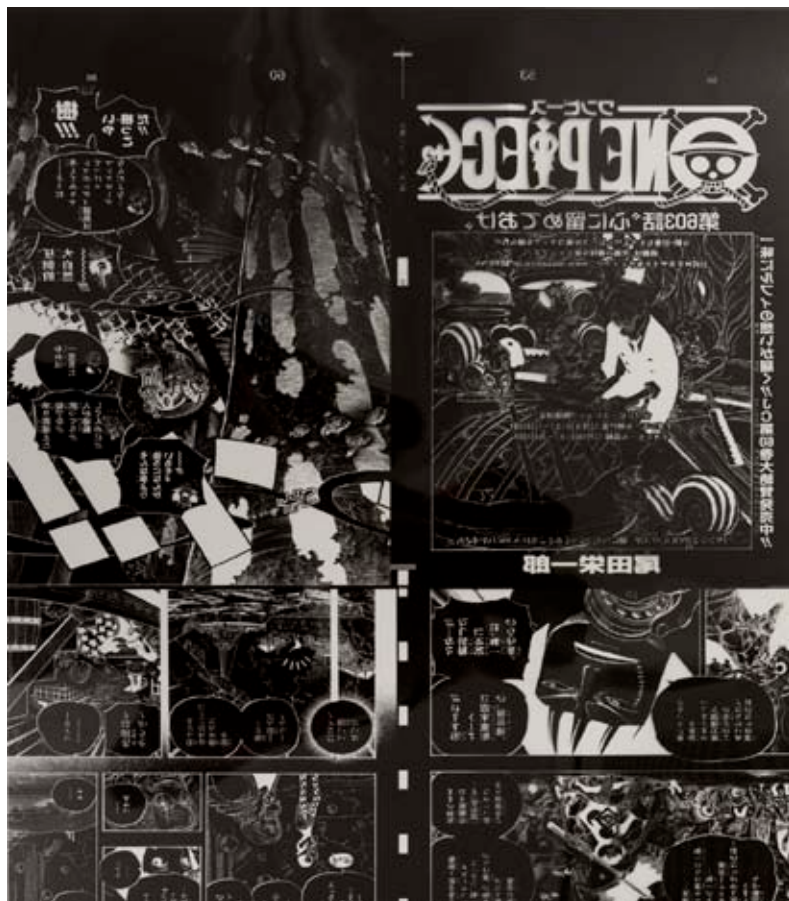
面付けされたデータは一度ネガフィルムに出力され、樹脂製の版におこす
