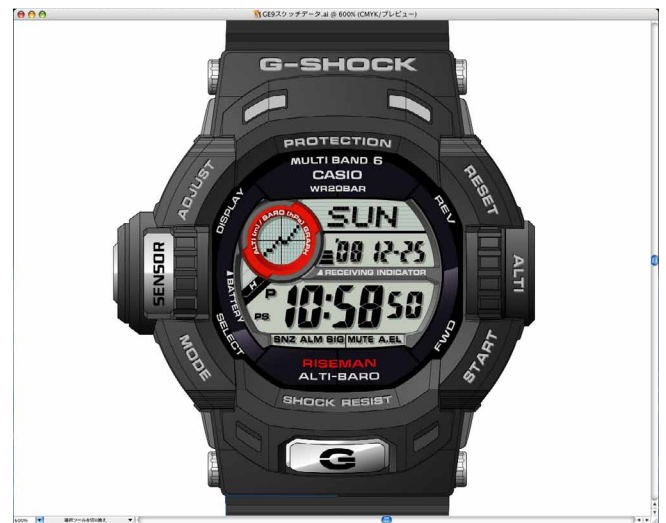
取り込まれたDXFデータをIllustratorで彩色した最終データ。最初に描かれたデザイン画と比べると、各所に修正が加えられていることがわかる。
