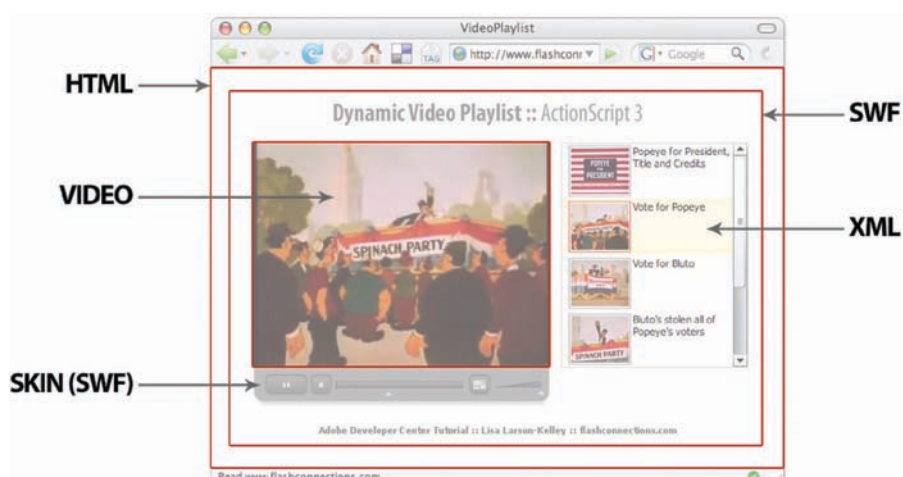
Bild A-1. De olika element som ingår i en videouppspelningsapplikation som skapats i Flash CS4 Professional. Den dynamiska spellistan i exemplet är inte obligatorisk.
