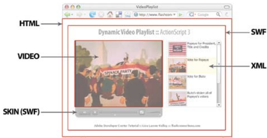
Abbildung A-1: Die verschiedenen Elemente eines Video-Players, der mit Flash CS4 Professional erstellt wurde. Diese Beispielanwendung umfasst eine optionale dynamische Wiedergabeliste.
